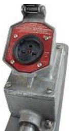
La sortie tolère les prises antidéflagrantes 6-15P et 6-20P
